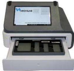
**2** Seleccionar y colocar pruebas a analizar.
